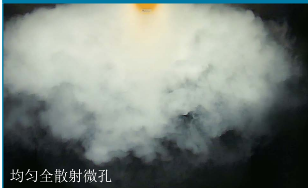
在毕高达研发中心进行的烟雾测试，模拟各种送风模式的实景
